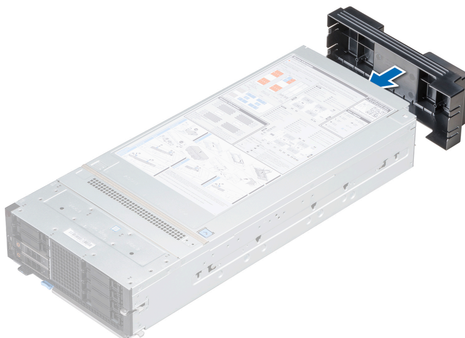
図 14. スレッドへの I/O コネクタ カバーの取り付け
