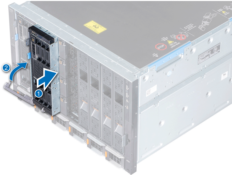
図 16. エンクロージャへのスレッドの取り付け
